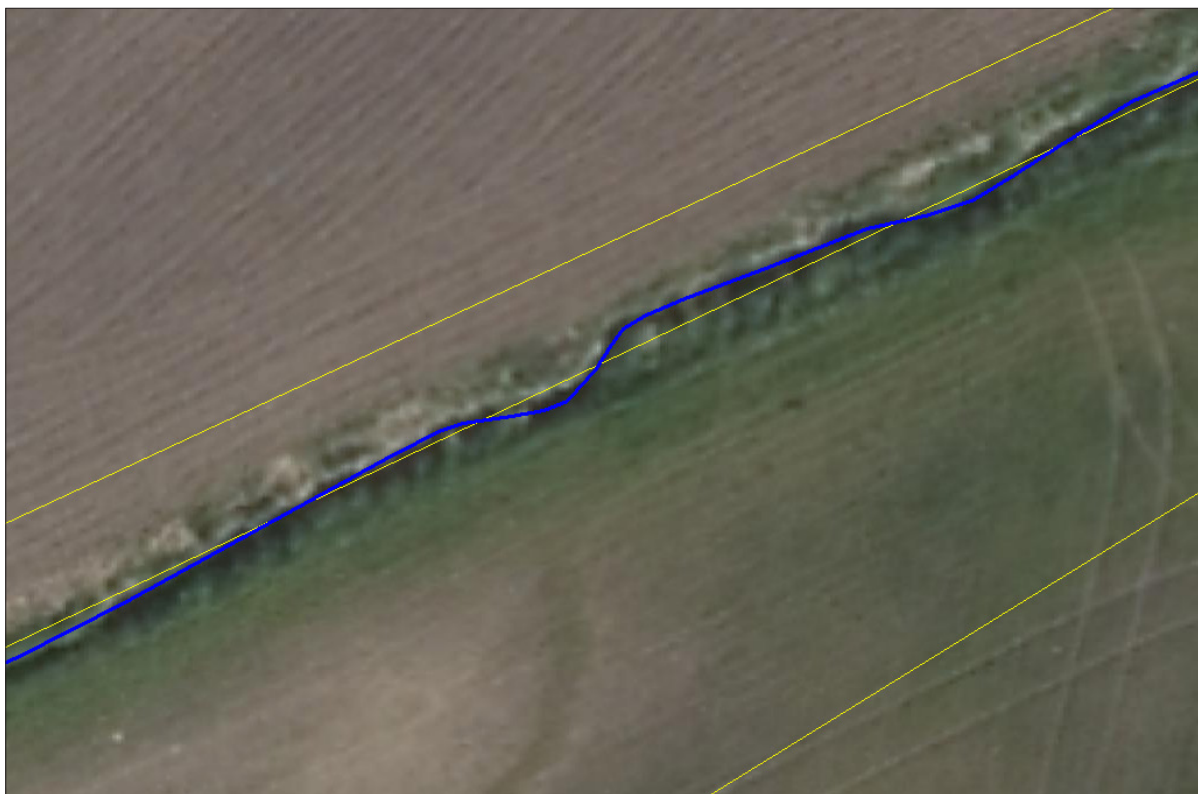
Rozdíl zákresu osy toku v základní mapě ČR u napřímeného koryta s počínajícím procesem renaturace oproti „přesným“ hranicím pozemku v katastrální mapě.
