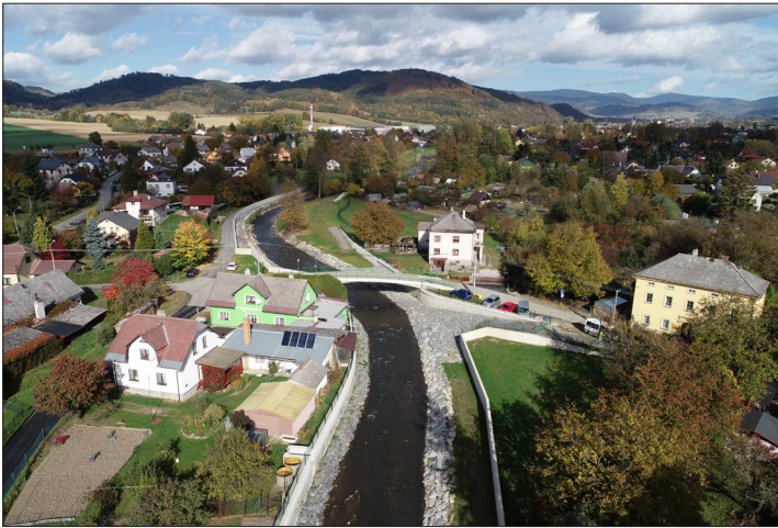
Kombinace druhů PPO včetně zkapacitnění mostu.
